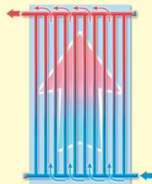
Schématické znázornění průtoku nemrznoucí směsi solárním kolektorem
